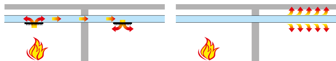
Il fuoco può propagarsi per convezione attraverso le aperture della condotta nel compartimento in cui è presente l'incendio.
