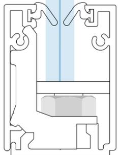
**La regolazione è garantita da un sistema a vite che mantiene il vetro/pannello allineato anche in presenza di pavimentazioni e soffitti fuori-squadra, agevolando il montaggio in tutti i contesti architettonici sia di nuova costruzione che in caso di restauro.**
