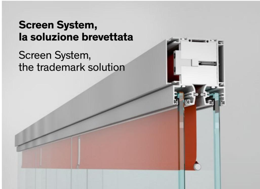
**Autmind ha messo a punto un sistema per alloggiare tra i due vetri tende tecniche, scorrevoli, a rullo, integrandole a scomparsa all'interno del binario superiore: in questo modo è in grado di gestire diversi gradi di luminosità e visibilità.**
