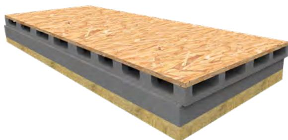
Sistema di isolamento termico acustico ventilato di coperture a falde con pannello stampato in Neopor® (EPS additivato con grafite) accoppiato a lana di roccia e OSB tipo 3 da 13 mm
