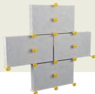
Schema di fissaggio tramite tassellatura
