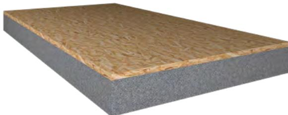
**Sistema di isolamento termico di coperture a falde in Neopor® (EPS additivato con grafite) accoppiato a pannello di OSB tipo 3 da 13 mm senza formaldeide.**
