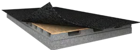
Sistema di isolamento termico ventilato di coperture a falde con pannello stampato in Neopor® (EPS additivato con grafite) accoppiato a OSB tipo 3 da 13 mm, preaccoppiato a guaina bituminosa ardesiata da 3,5 kg.
