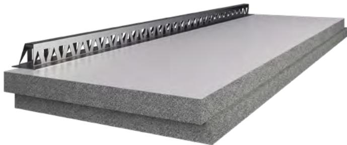
**Sistema di isolamento termico ventilato di coperture a falde con pannello stampato in Neopor® (EPS additivato con grafite) accoppiato a lamina in alluminio goffrato con listelli fissa-tegola in acciaio zincato.**
