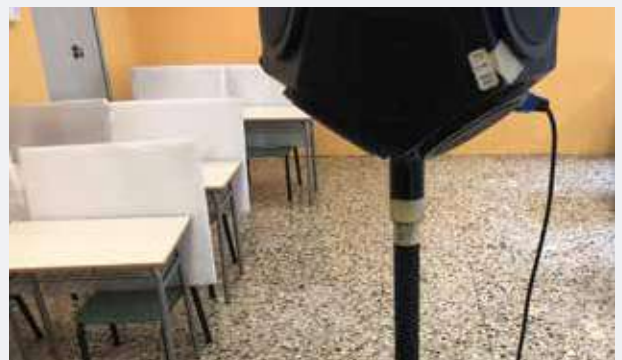
Figura 3.34 - Posizionamento dei pannelli fonoassorbenti in fibra 100% poliestere per la simulazione dell'occupazione dell'aula.
